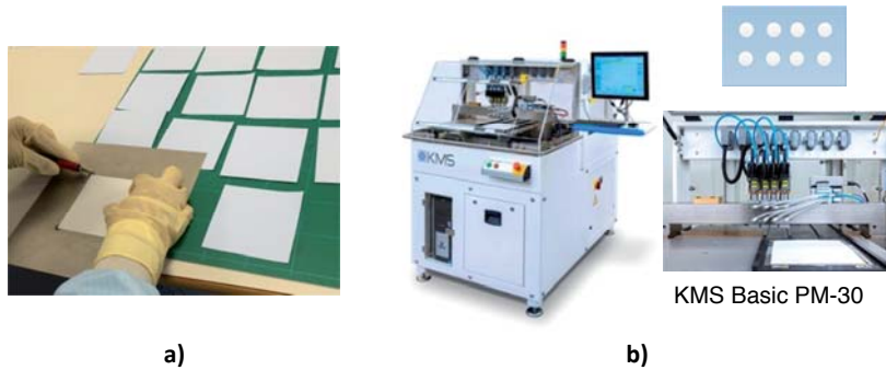
Figura B.6 Proceso de taladrado de vías.
