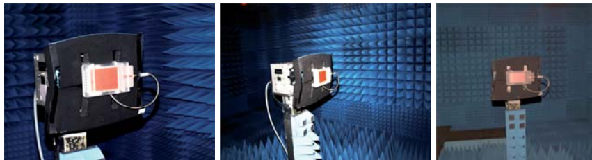
Figura 7.51 Montaje en la cámara anecoica.
