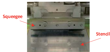
Figura 2.14 Proceso de relleno de vías.
