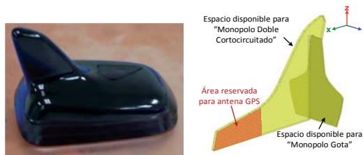
Figura 5.28 Radomo como forma de aleta de tiburón y cortes de la estructura que se utilizarán para imprimir los monopolos.
